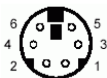
Obr. 6 – Konektor X6 – připojení PS2 klávesnice
