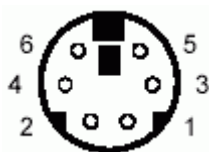
Obr. 6 – Konektor X6 – připojení PS2 klávesnice
