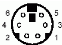
Obr. 6 – Konektor X6 – připojení PS2 klávesnice
