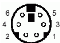
Obr. 6 – Konektor X6 – připojení PS2 klávesnice
