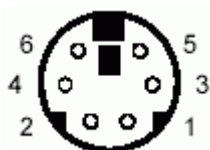
Obr. 6 – Konektor X6 – připojení PS2 klávesnice
